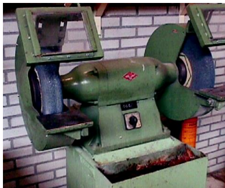
- vast opgestelde slijpmachine met beschermkap en beschermruit
