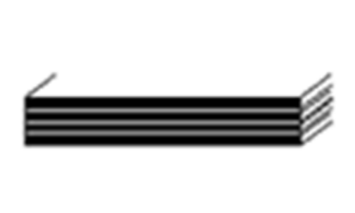
Afb. 41 Doorsnede meerlaagse grafietspijkerplaatpakking
