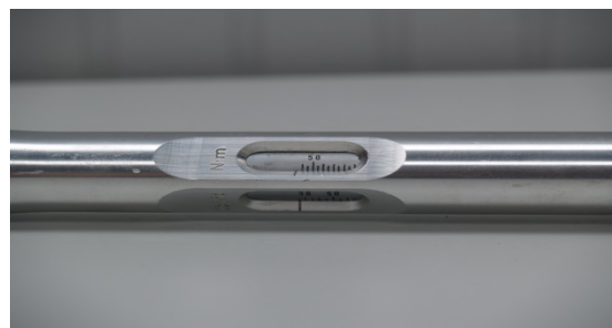
Afb. 21 Twee soorten aflezingen van het ingestelde moment, in Nm en in lbsft
